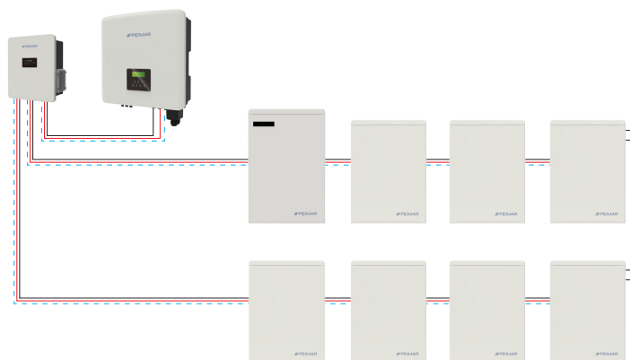
Connexion avec un PSI-X-PRL-BMS-2 et 7 modules batterie PSI-X-5.8SLV-V2
