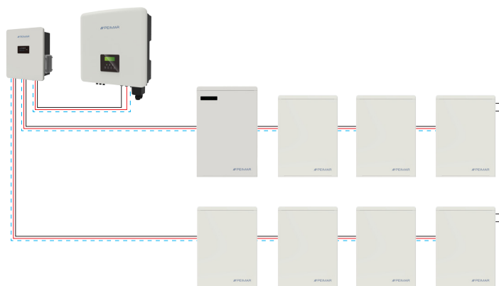
Collegamento con un PSI-X-PRL-BMS-2 e 7 moduli batteria PSI-X-5.8SLV-V2
