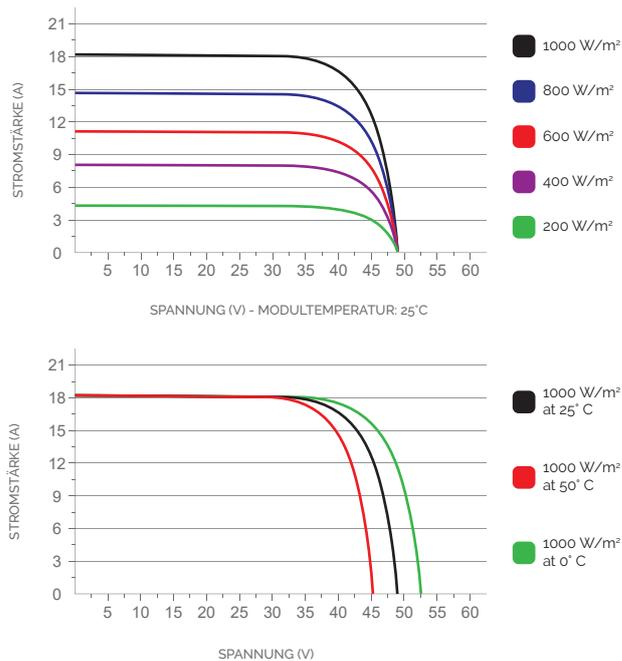
1. STC (Standard Test Condition): Bestrahlungsstärke 1000W/m<sup>2</sup>, Modultemperatur 25°C, Luftmasse 1,5
