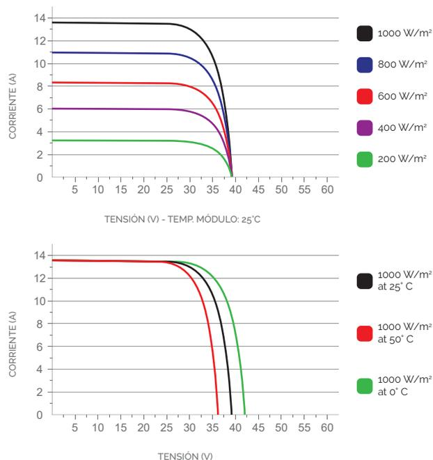
1. STC (Standard Test Condition): Irradiación 1000W/m<sup>2</sup>, Temperatura del módulo 25°C, Aire 15
