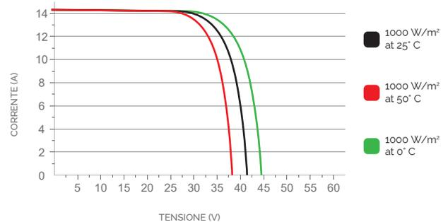
1. STC: (Standard Test Condition) Irraggiamento 1000W/m<sup>2</sup>, Temperatura Modulo 25°C, Massa d'aria 1.5
