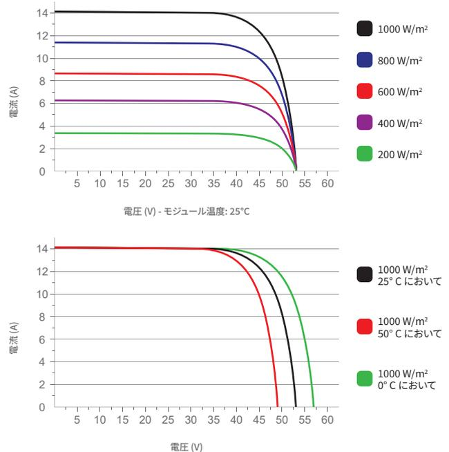
1. STC: (標準試験条件) 放射照度 1000W/m<sup>2</sup>; モジュール温度 25°C; エアマス 1.5
